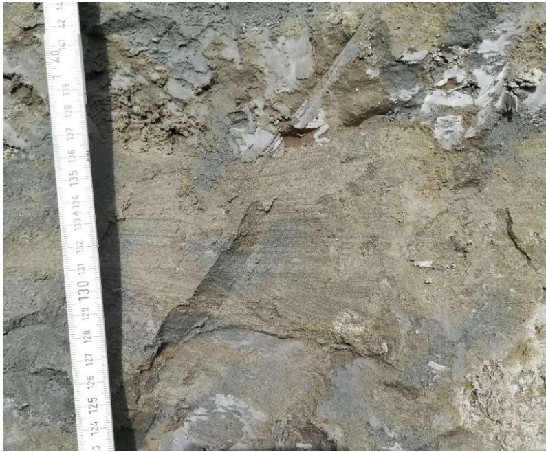
Figuur 8. Wand 2, observatiepunt 1. Voorbeeld van de hummocky structuren. Foto F_VLA17-4-1-008-W2-02.
