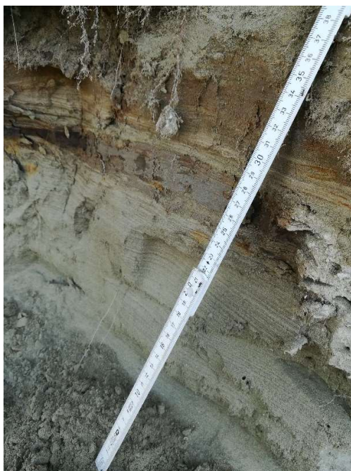
Figuur 9. Wand 3, ongeveer 1 meter ten noorden van observatiepunt 1. Pakket 86-116 cm en Pakket 116-141 cm, met onderaan het gelamineerde zand en bovenaan de afwisseling van kleilagen en gelamineerd zand. Foto F_VLA17-4-1-008-W3-01.
