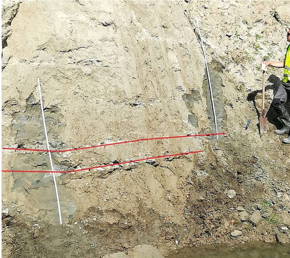
Figuur 7. Profiel van Wand 2. Door uitdroging zijn de dikkere kleilagen goed te vervolgen. Onderaan de kleilaag van 68-82 cm, observatiepunt 1, bovenaan de kleilaag van 99-109 cm in observatiepunt 1 en 1-13 cm in observatiepunt 2. Ten gevolge de onregelmatigheid van de wand zijn er enkele knikken in de rode lijnen. Foto F_VLA17-4-1-008-W2-01.
