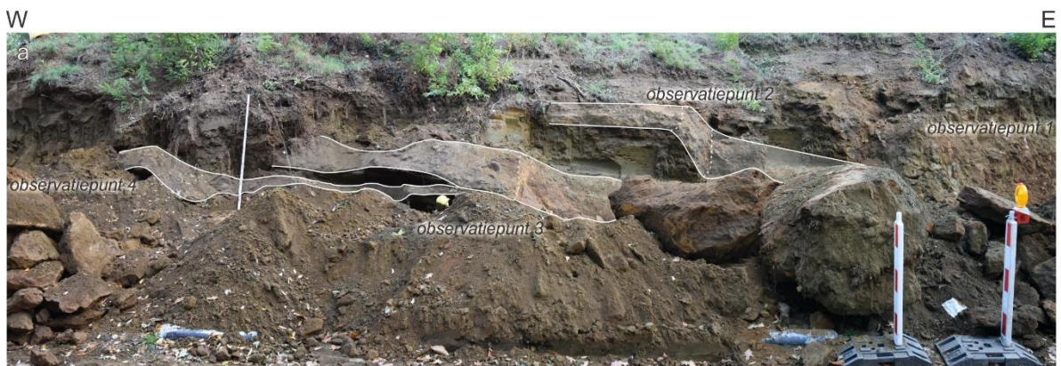
Figuur 9. Deel van Wand 2 met voorkomen van zandsteenbanken in de bocht van de weg, met aanduiding van de observatiepunten. Het zuidoosten van het bovenste deel (a) sluit aan op het westen van het onderste deel (a). Het voorste breukvlak van de zandsteenbanken is aangegeven in wit, de waarneembare verbreiding in stippellijn. Net ten zuidoosten van observatiepunt 6 is de zandsteenbank gebroken en gekanteld, aangegeven in oranje. Foto's F_VLA17-4-1-006-W2-04 en F_VLA17-4-1-006-W2-06.
