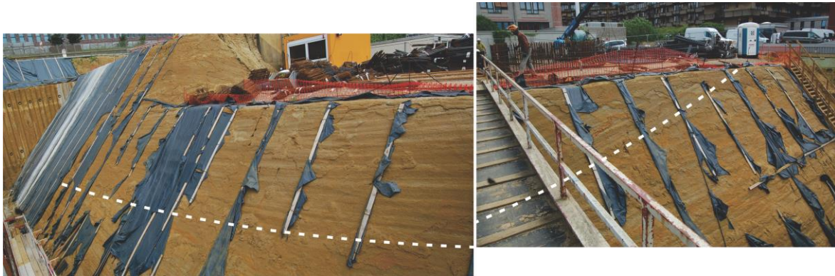
Figuur 8. Samengesteld overzicht van Wand 16, met aanduiding van het contactvlak van de geulopvulling met de onderliggende afzettingen. (F_VLA17-4-1-001-W16-04 en F_VLA17-4-1-001-W16-05)
