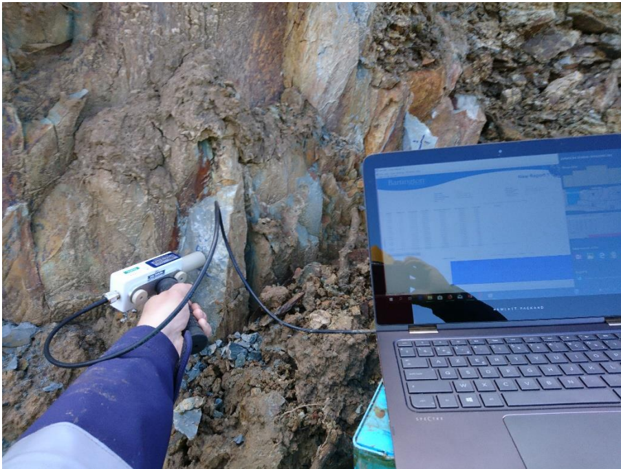
Figuur 8. Meting van magnetische susceptibiliteit op het terrein door middel van een draagbare susceptometer.
