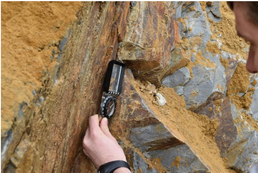
Figuur 11. Opmeting van helling en strekking van de gelaagdheid van de leisteen.
