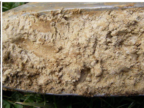
compacte fijnkorrelige krijtlaag, in-situ ? ca 1.25 m (foto L. Lenaerts)
