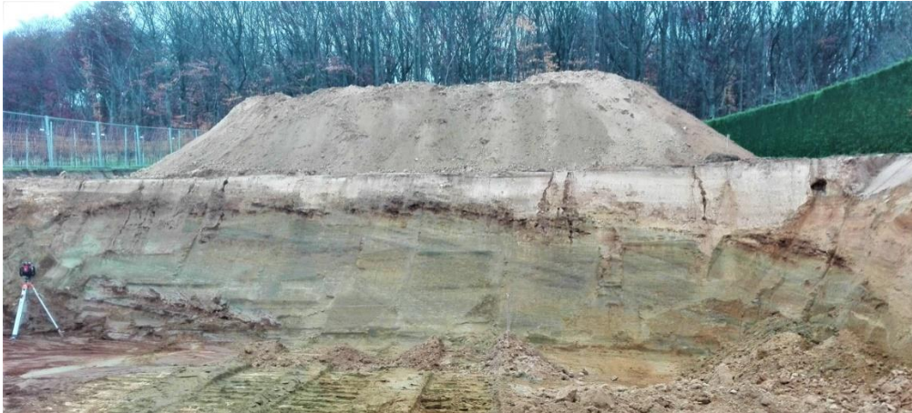
Foto 6. Achterwand bouwput (noordzijde volgens richting N85E) in groengekleurd kleiig Zand van Diest met duidelijk afgetekende foreset hellingen, 9° afhellend in oostelijke richting, te herkennen op donkere meer kleiige laminaties die min of meer verijzerd zijn of aanleiding geven tot het ontstaan van ijzerzandsteenbanken, verspringend volgens de foresetvlakken (rechtsboven en linksonder). Het zand tussen deze verijzeringsvlakken lijkt structuurloos door verwerking. Bovenaan door podzolizatie bleekgeel verkleurd lemig zand met toenemende dikte in oostelijke richting, ontwikkeld in het geologisch substraat (foto M. Dusar, 26.11.2019).
