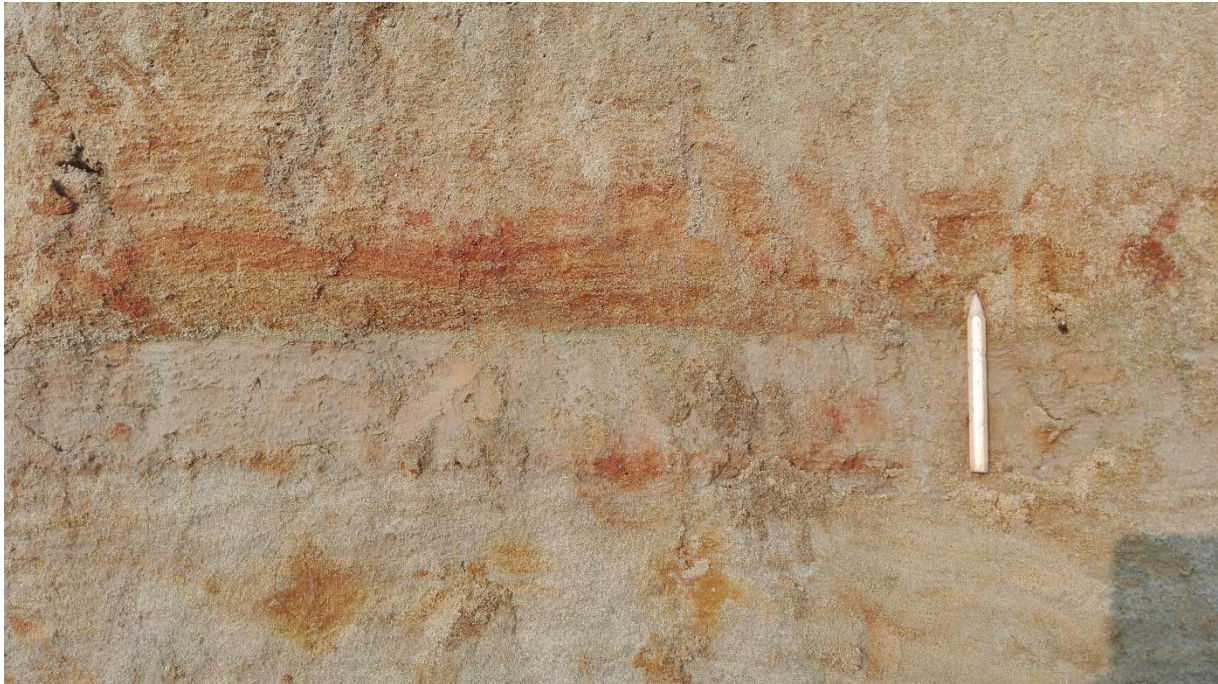
Bouwput Schotelveldstraat 4-6 Wilsele, midden in beeld ter hoogte van potlood een horizontale 7 cm dikke zalmkleurige sterk kleiige zandlaag, langs onder en boven omgeven door gelimonitiseerde horizonten met beginnende verstening.
