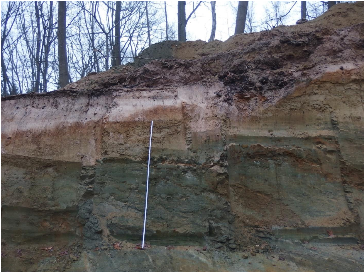
Foto 19. Bouwput Kwikstaartweg 72 Rotselaar. Aan de voet van de helling is een podzolbodem bewaard, die hogerop de helling door colluvium lijkt te zijn afgesneden. In dit bodemprofiel zijn de gebleekte en de oranjebruine textuur A en B horizonten waar te nemen, gevormd in de regoliet, bovenop het moedergesteente (de groene laag), waarin oxidatiefronten en dunne goethietlaagjes voorkomen.
