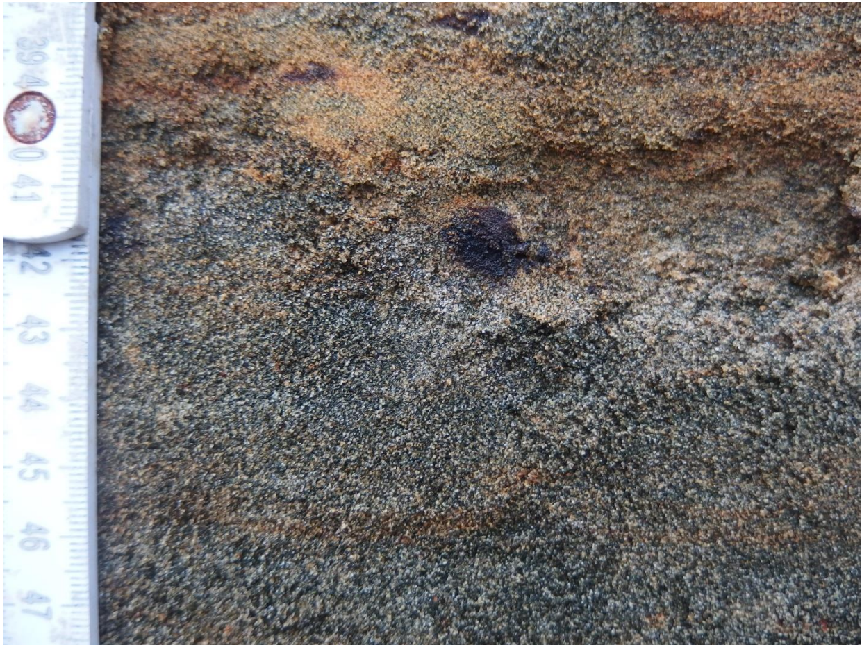
Foto 11. Bouwput Kwikstaartweg 72 Rotselaar. Detail opname van ca 1 cm grote zwarte kern in groen zand, met zwart afgevend verpoederd metaal(hydr)oxides (ijzer - mangaan).
