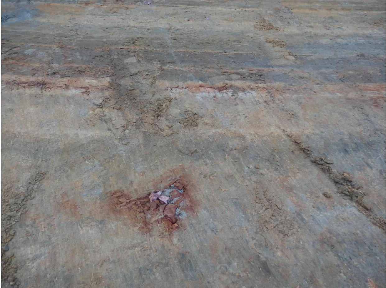
Foto 13. Bouwput Kwikstaartweg 72 Rotselaar. Limonietconcretie in het grijsgroene zand in de bodem van de bouwput, omgeven door een roestaureool. Foto genomen in NNE richting.
