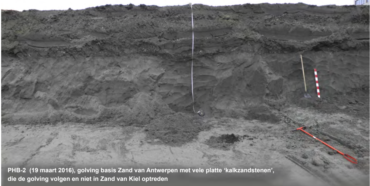
Fig. 8: PHB-2. Golvende basis van het Zand van Antwerpen, die heel wat kenmerkende kalkzandstenen bevat.
