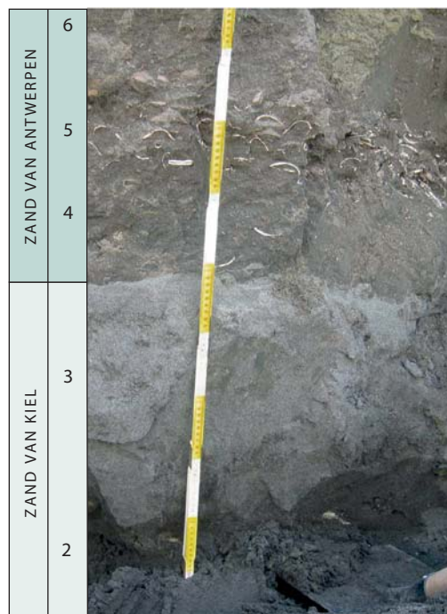
Fig. 5. Detail van de scherpe lithologische grens tussen de Zanden van Kiel en Antwerpen in een droog profiel. — Detail of the sharp lithological boundary between the Kiel and Antwerpen Sand Members in a dry profile (August 2015).
