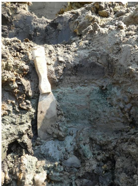
Figuur 19: Scherpe overgang aan de top van de klei. (foto: F_VLA17-4.1-007-W3-032)
