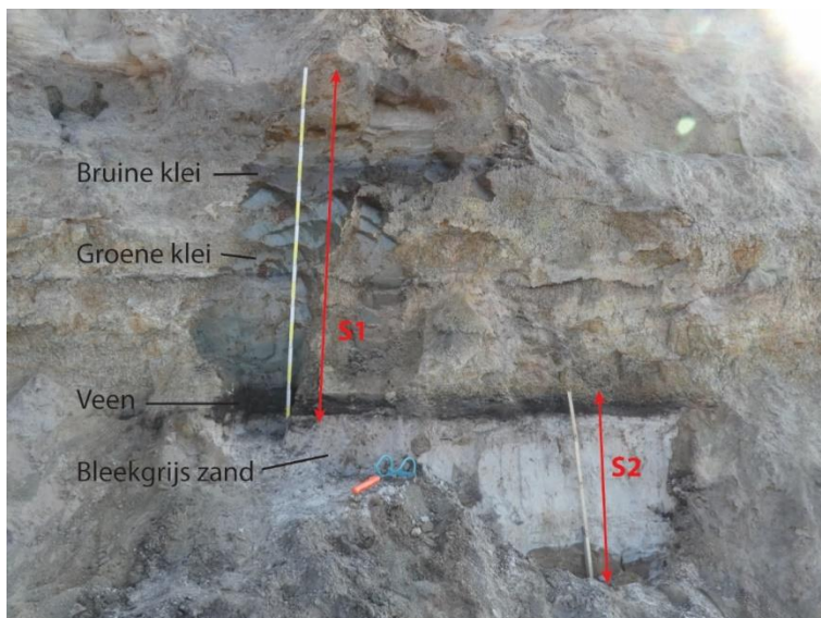
Figuur 8: Situering van observatiepunten S1 en S2 en de verschillende lithologische eenheden. (foto: F_VLA17-4.1-007-W1-004)
