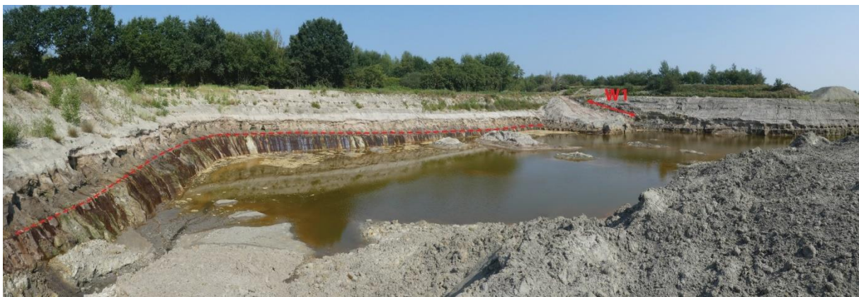
Figuur 6. Overzicht van de noordwestelijke wand van de groeve, inclusief profielwand W1. Merk op het uittredende grondwater boven een slecht-doorlatende kleilaag (Lid van Rijkevorsel); deze kleilaag helt af in zuidelijke richting (van links naar rechts; rode stippellijn). Opname in NW richting. (foto: F_VLA17-4.1-007-P-001)
