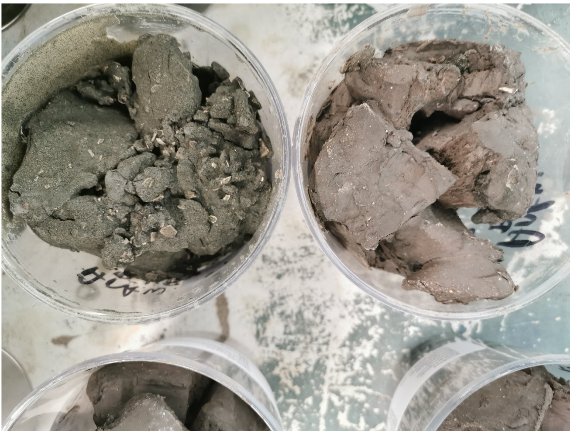
GEO_19-122 B4A, 42.5 – 43.5 m, overgang Formatie van Voort – Formatie van Boom.
