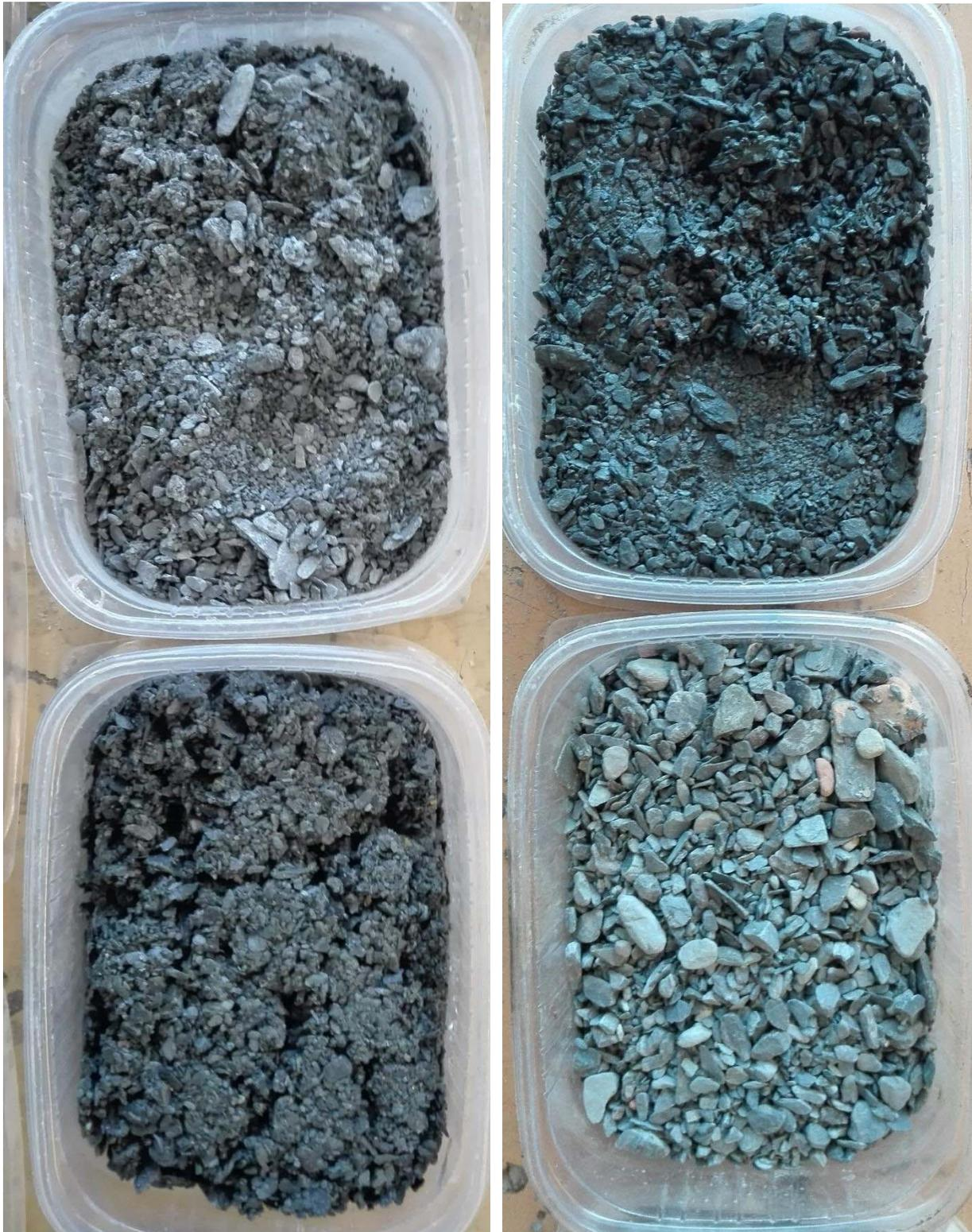
Sondage géothermique Saintes-1, 115W0365, du haut en bas, à gauche 69-70 m et 70-71 m, à droite 72-73 m et 73-74 m.
