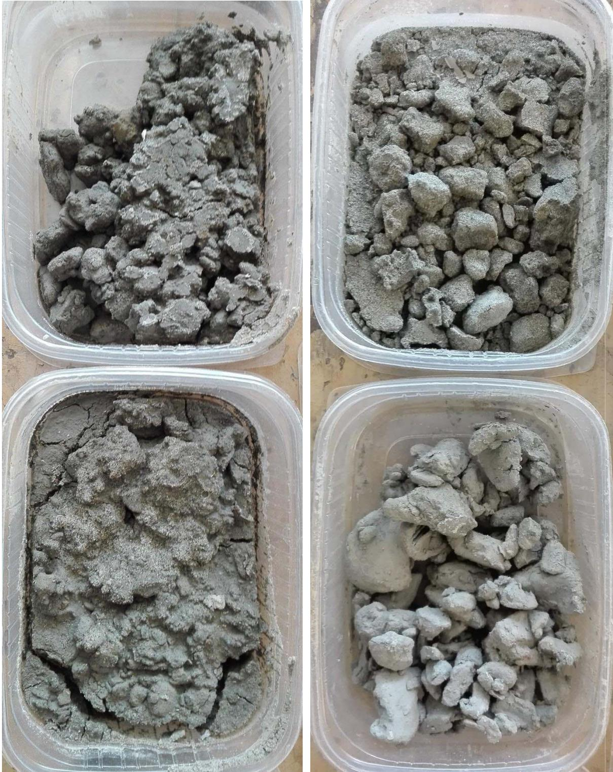
Sondage géothermique Saintes-1, 115W0365, du haut en bas, à gauche 12-13 m et 13-14 m, à droite 14-15 m et 15-16 m.
