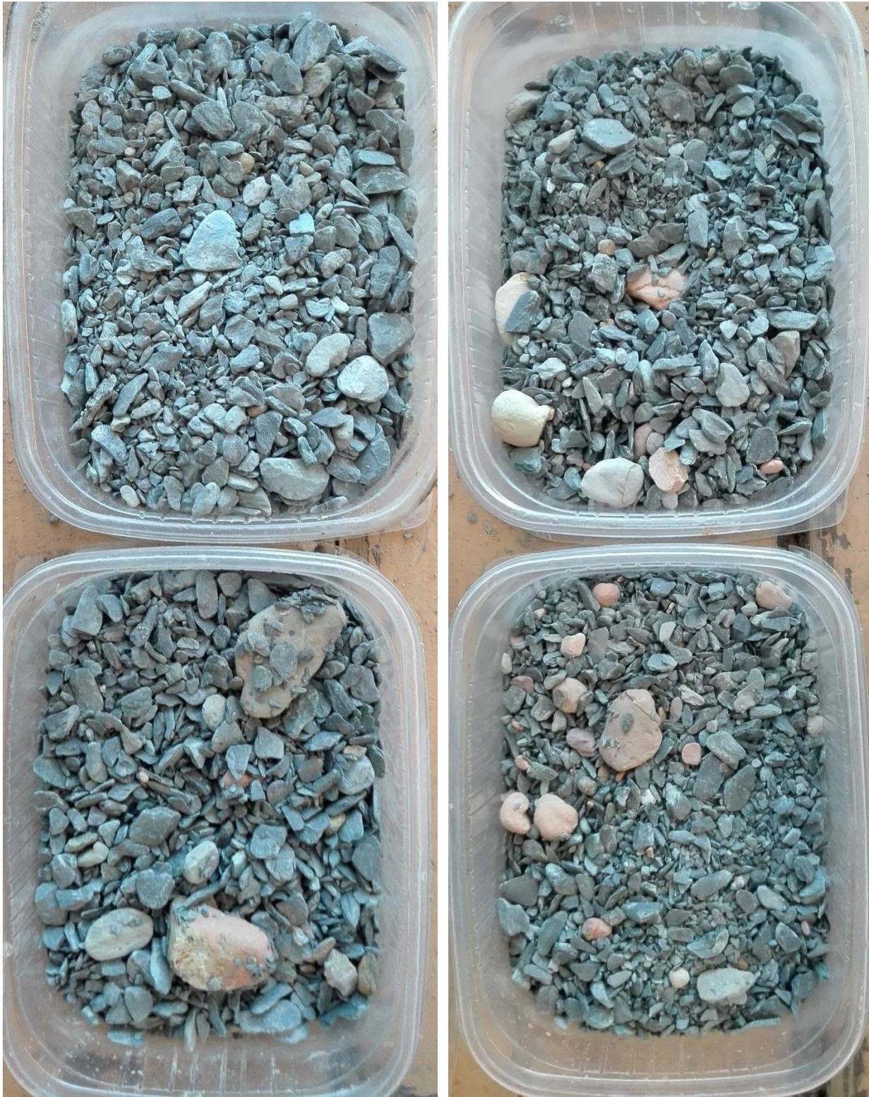
Sondage géothermique Saintes-1, 115W0365, du haut en bas, à gauche 74-75 m et 75-76 m, à droite 76-77 m et 77-78 m.
