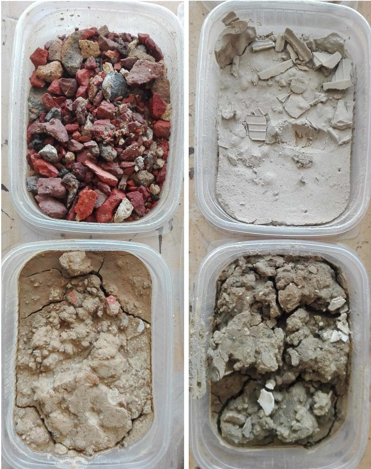
Sondage géothermique Saintes-1, 115W0365, du haut en bas, à gauche 0-1 m et 1-2 m, à droite 5-6 m et 6-7 m.
