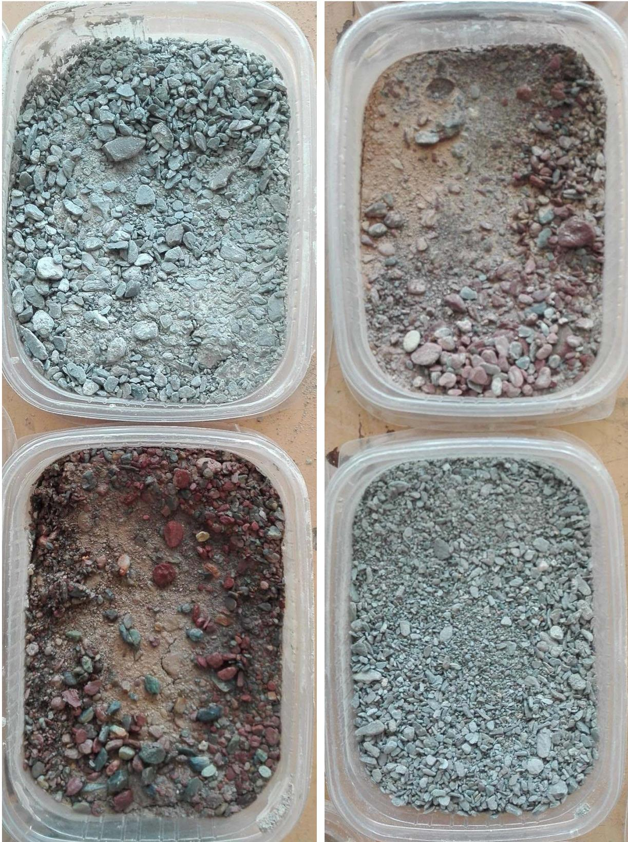
Sondage géothermique Saintes-1, 115W0365, du haut en bas, à gauche 55-56 m et 56-57 m, à droite 57-58 m et 58-59 m.
