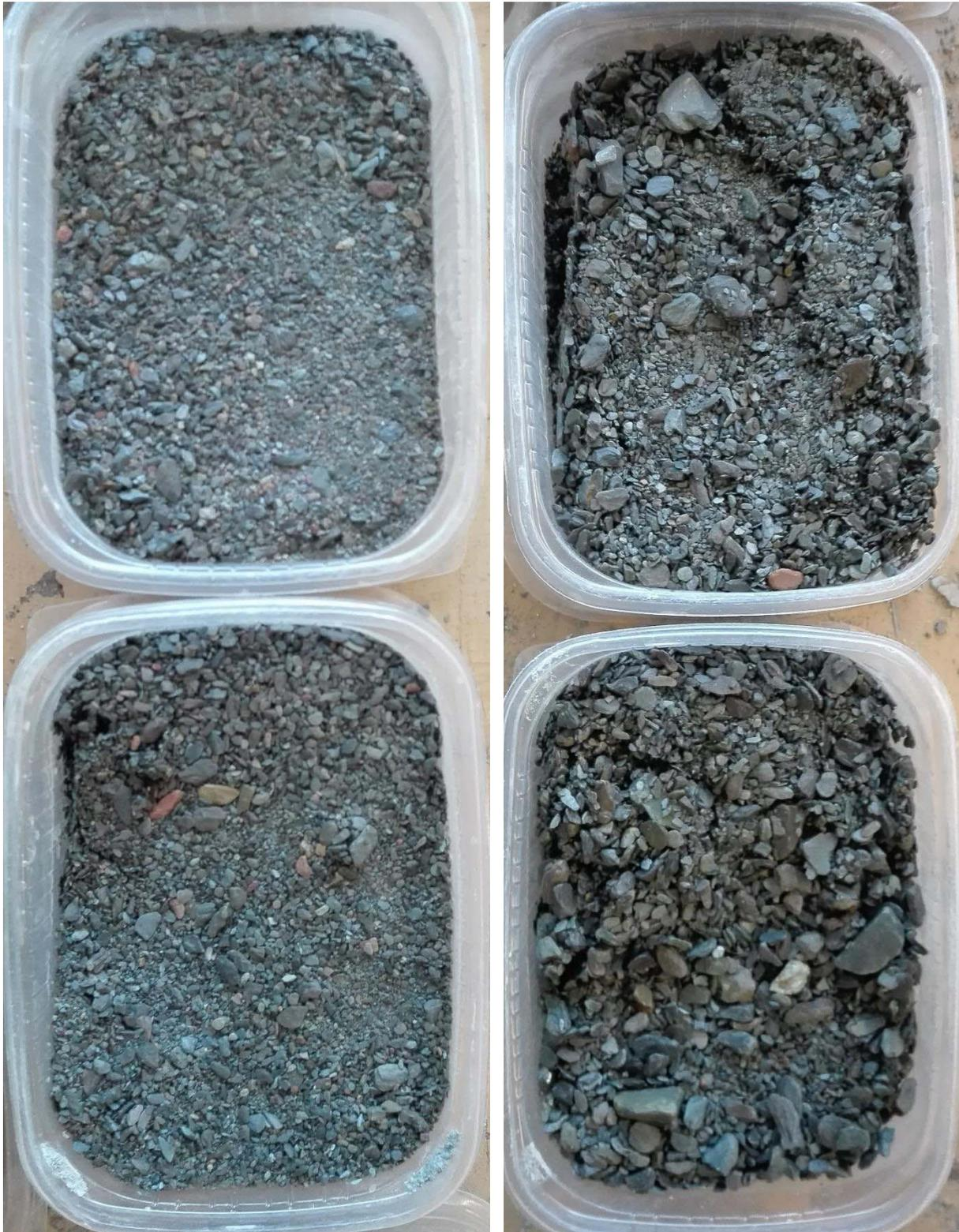
Sondage géothermique Saintes-1, 115W0365, du haut en bas, à gauche 61-62 m et 62-63 m, à droite 65-66 m et 66-67 m.
