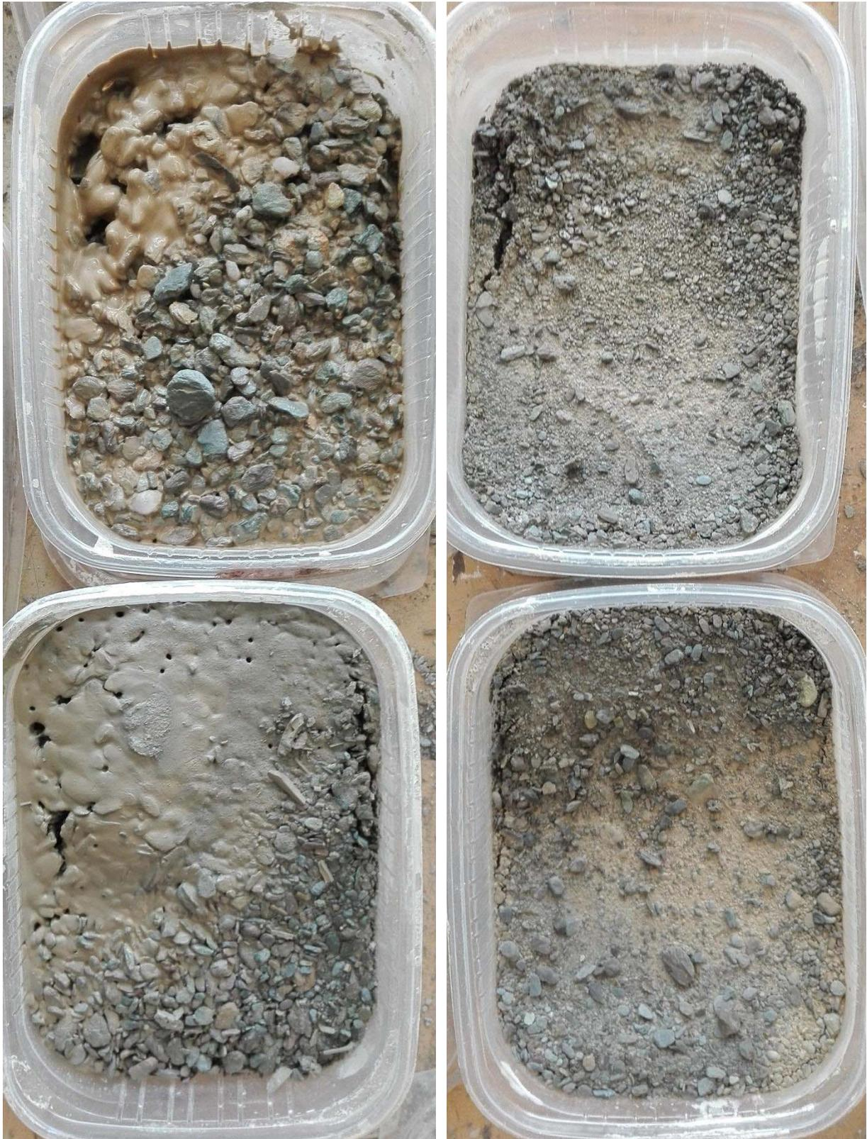
Sondage géothermique Saintes-1, 115W0365, du haut en bas, à gauche 40-41 m et 41-42 m, à droite 46-47 m et 47-48 m.
