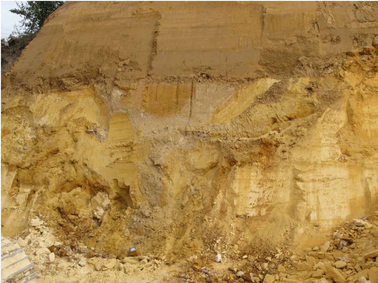
Bouwput Millerweg 1-3, met subhorizontaal contact leem - tufkrijt, gemarkeerd door een basisgrind. In het tufkrijt een doline gevuld met beperkt vuursteeneluvium, Oligoceen zand en Quartaire leem (foto Ludo Indeherberge, 18.10.2016).
