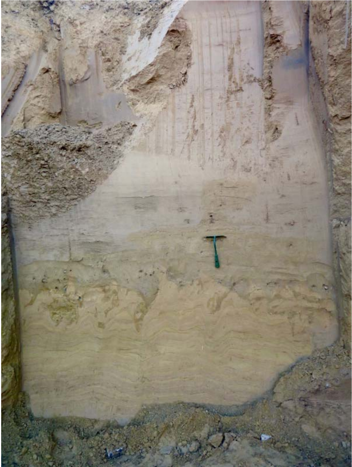
Foto 2: Cryoturbaties (?) op contact tussen bruine leem (lithologische eenheid A - boven) en lithologische eenheid B (fijn gelamineerde afwisseling zand-zandige klei) (onder) – verspreide silexkeien zichtbaar op contact. Lokaal zijn er grindlensjes en zandlenzen aanwezig in top van onderste pakket (andere wand, aan de overzijde van dit profiel)
