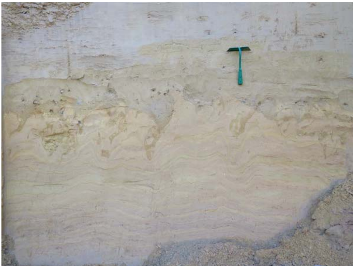
Foto 3: Detail van vorige foto – let op verstoord contact tussen lithologische eenheid A en B
