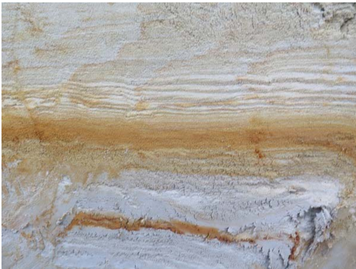
Foto 14 – detail van vorige foto 13 – oxidatiezone in wit fijn-gelamineerd zandlaagje (zandinterval in kleilaaag)
