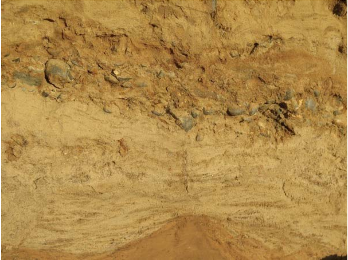
Foto 7: detail van contact tussen A en B – verstoord gelamineerd grover zandpakket vlak onder grindlaagje aan top van eenheid B, vlak aan basis van A (concentratie van silexkeien)
