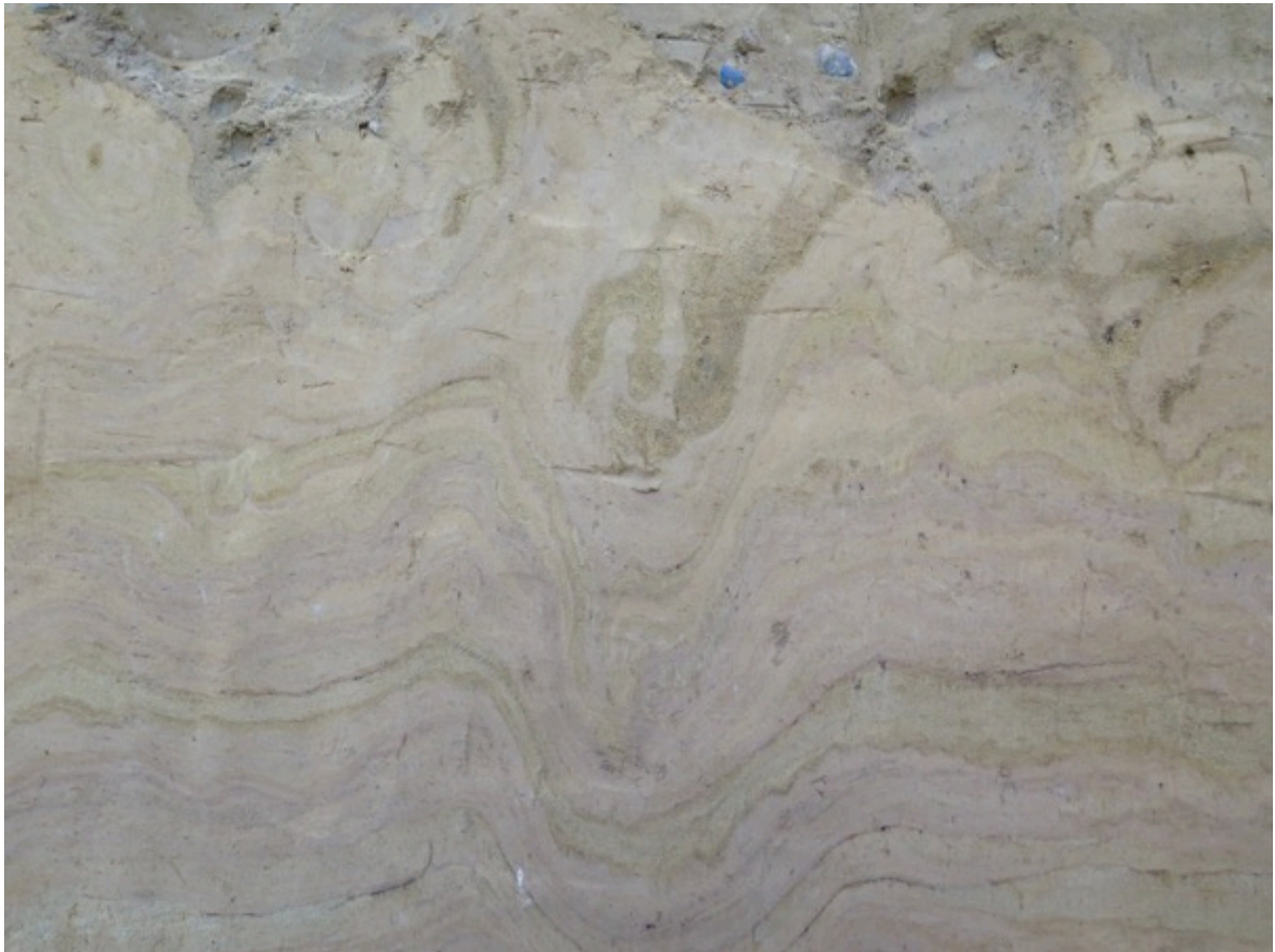
Foto 4 – detail van foto 2 – verstoord contact tussen A (leem) en B (zand-klei-afwisseling). Let op aanwezigheid van blauwgrijze silexkeien aan basis leem. Lichtere kleuren zijn zandrijke sedimenten, donkere kleuren zijn kleirijke sedimenten. Opvallend verwrongen donkere vlek bovenaan is grover (nat) zand.
