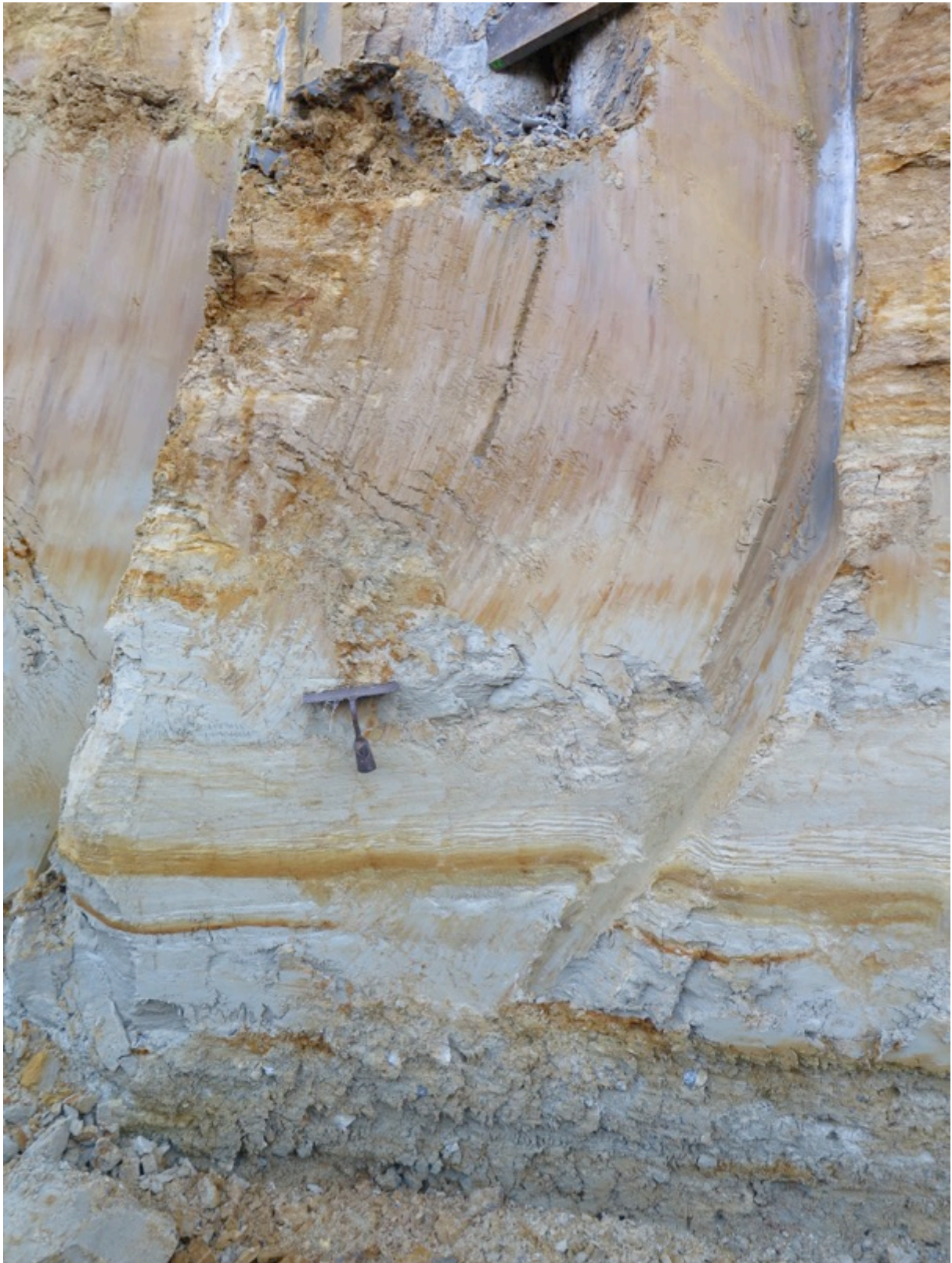
Foto 11 – detail van roodbruin-paarsig rood gekleurde oxidatie zone (boven), vlak boven kleiige (bleekgrijze) eenheid C. Donkerbruin oxidatielaagje aan basis van wit gelamineerd zandlaagje in kleipakket. Onderste eenheid is grindpakket in kleig zand (eenheid D)
