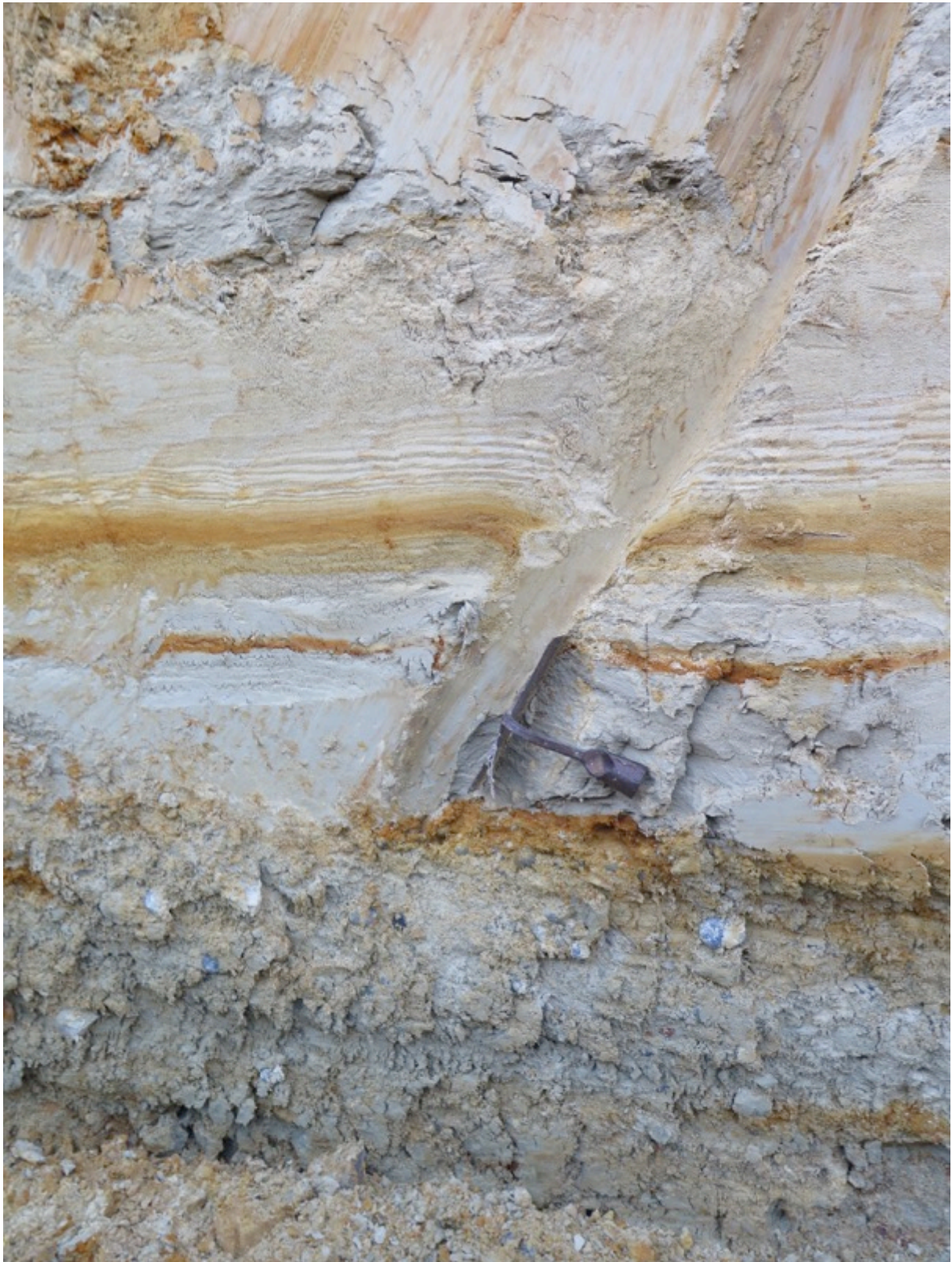
Foto 13 – detail van vorige foto met mooi gelamineerd zandig laagje vlak boven kleipakket (midden) en kleiig-zandige grindzone (onder) – bodem van put is harde glauconietrijke mergel (eenheid E)
