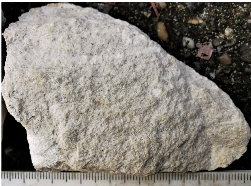
Lithotheek monster 104W0647/3. Breukvlak met korreltextuur en enkele parallelle witte mergelige bandjes (subhorizontaal in beeld, licht naar links afhellend), overeenkomend met gelaagdheidsvlakken.
