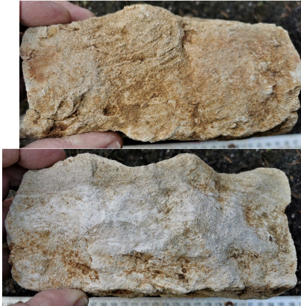
Lithothèque monster 104W0647/2, verweerde en minder verweerde zijden met herkenbare sedimentaire structuren in doorsnede: witte mergelige laminaties, lichtgrijze zandiger lens (in omgekeerde positie op niet lemig oppervlak, onderaan) en vullingen van graafgangen (op leembruin vlak, bovenaan).
