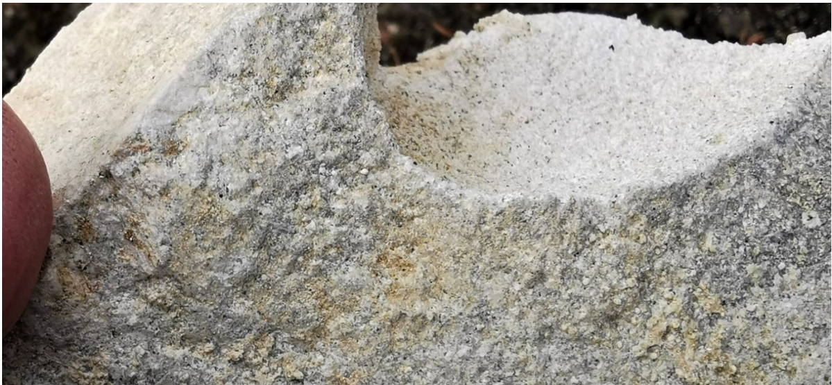
Lithotheek monster 104W0647/1. Doorgebroken lichtgrijs interieur van platte grotsteenknol in kwartsrijke licht glauconiethoudende (tot 2%) vrij slecht gesorteerde fijn- tot middelmatige zandsteen met kiezelcement, met kalkbioklasten van wisselende grootte tot >1 mm.
