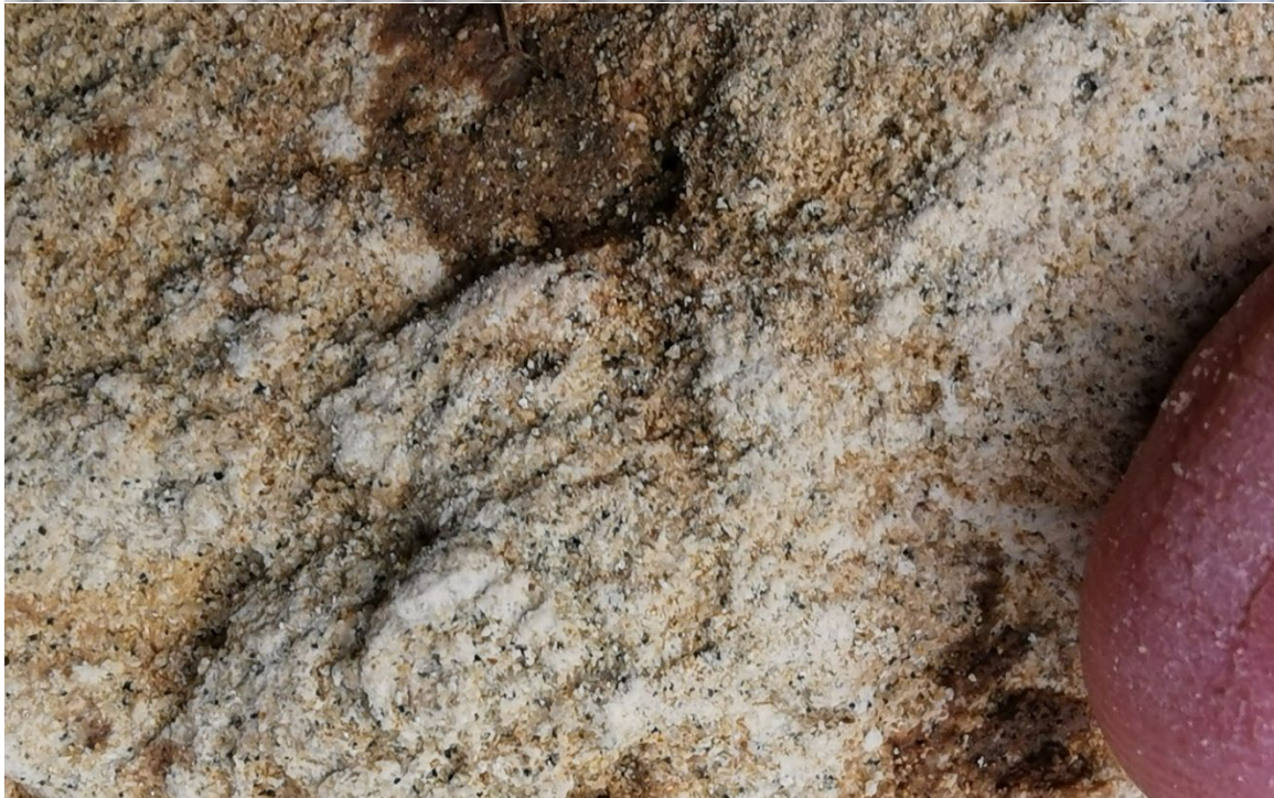
Lithotheek monster 104W0647/2, detail van korreltextuur ingebed in micrietische kalkmatrix, licht door glauconiet gespikkeld.
