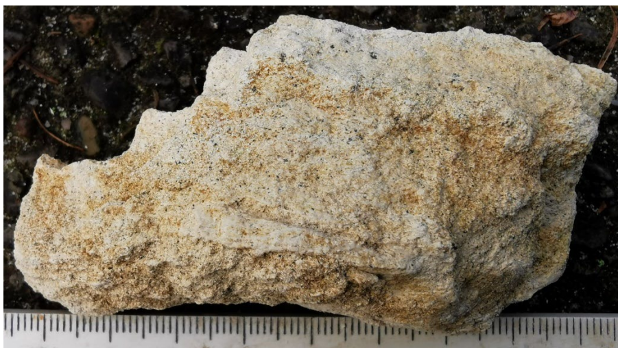
Lithotheek monster 104W0647/3. Verweerd en leemkleurig verkleurd buitenvlak van de massieve kalksteenbank van licht glauconiethoudende zandige kalksteen met uitgeëtst mergelig bandje.
