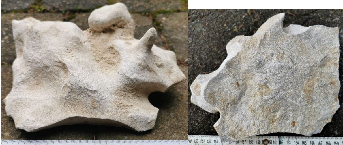
Lithotheek monster 104W0647/1, grotsteen van max 18x13x7 cm uit de verstoorde toplagen van de Formatie van Brussel in het zinkgat, niet-georiënteerde afbeelding van boven- en onderzijde.
