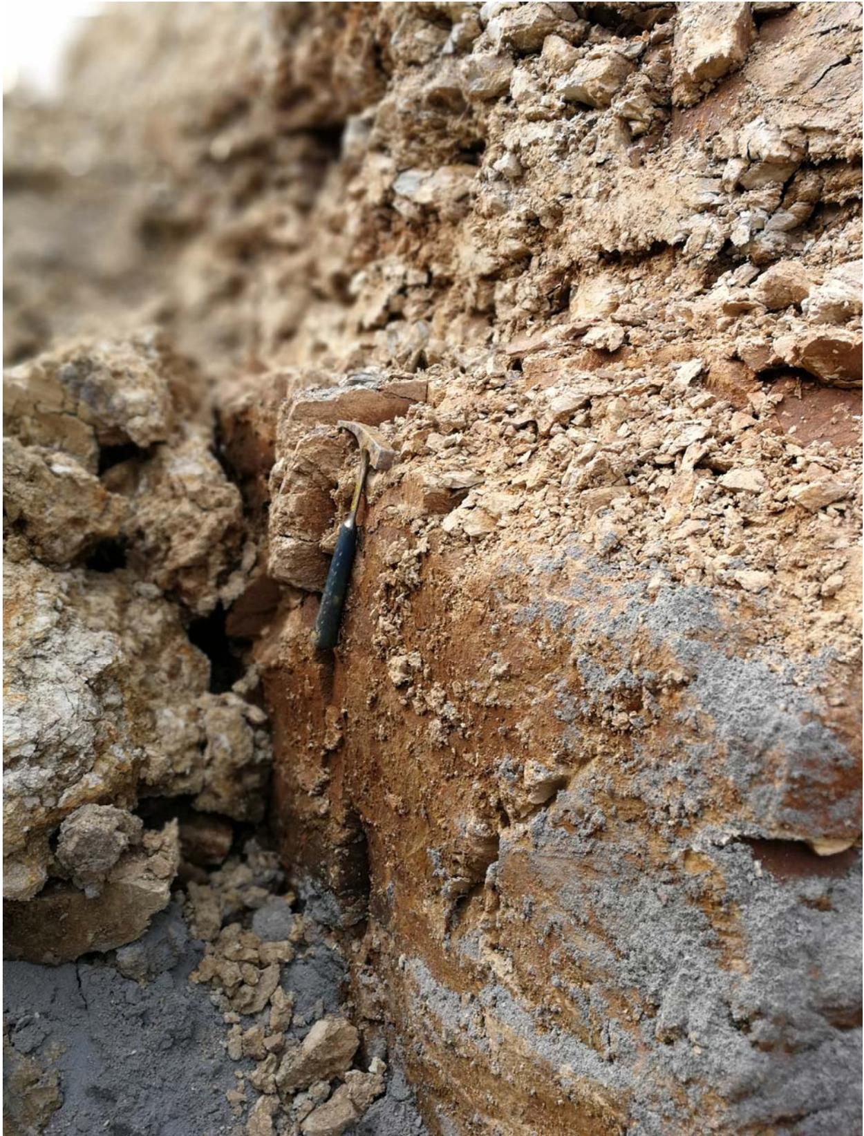
Vue de tranchée, lieu du profil décrit, sommet du banc inférieur bien diaclasé et contact au pic du marteau avec tuffeau plus argileux finement fracturé.
