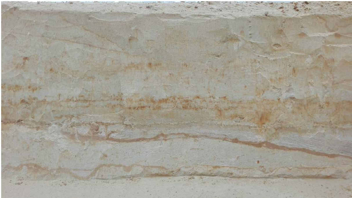
1 m hoog profiel door geelwit matig-fijn zand zonder sedimentaire structuren, met roestige vlekken in horizontale banden geconcentreerd (geoxideerde gley) en onderaan eveneens roestbruine kleihoudende lenzen als inspoelingsniveaus; 1 m diepe put onderaan bouwput Gellenberg 4 te Lubbeek (MD, 6.10.2017).
