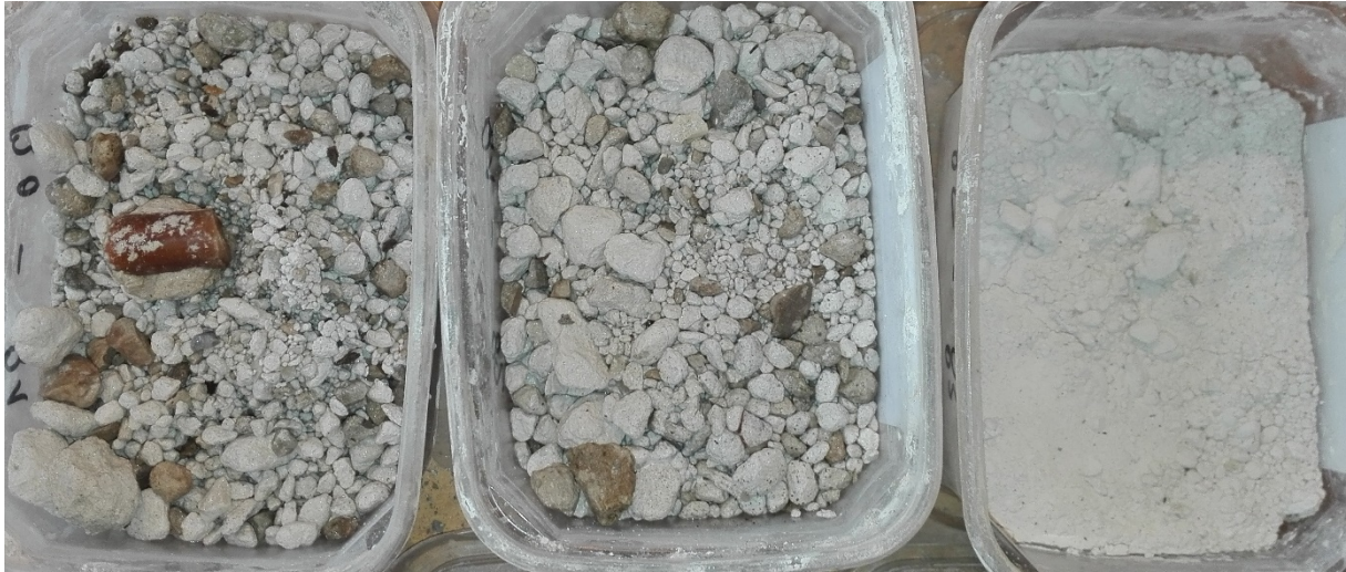
Foto 9. Cuttings interval 80 – 83 m in wit schrijfkrijt van het lid van Zeven Wegen, onderste eenheid van de Formatie van Gulpen; monsters 80 – 81 en 81 – 82 m vertonen grotere krijtcuttings, vermengd met beige fosfaatbollen (naval) en met groot belemnietfragment (monster 80 – 81 m), terwijl monster 82 – 83 m fijn vermalen wit krijt is met wat fijne zwarte silexsplinters, het gebruikelijk voorkomen van cuttings in wit schrijfkrijt.
