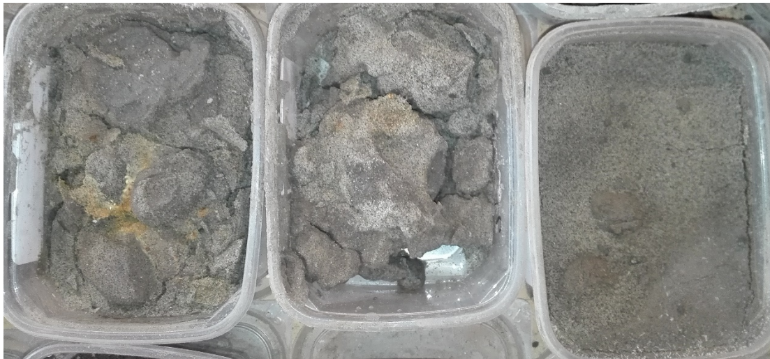
Foto 4. Cuttings interval 25 – 28 m; links en midden (monsters 25 – 26 en 26 – 27 m) nog grote brokken grijze compacte klei van het Lid van Orchies van de Formatie van Kortrijk, zandrijker aan de basis (26 – 27 m), als naval vermengd met fijn bleekgrijs licht met glauconiet gespikkeld zand; rechts hetzelfde zand van het Lid van Grandglise van de Formatie van Hannut (overgang leperiaan – Landeniaan sequenties).
