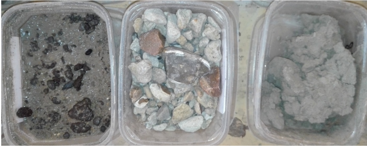
Foto 3. Cuttings interval 15-18 m, overgang van Pleistoceen fluviatiel zand naar leperklei, met grens Quartair – Tertiair (Quartair basisgrind op 17 m).
