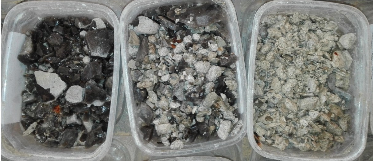
Foto 7. Cuttings interval 72 – 75 m, basis Formatie van Gulpen, equivalent van het Lid van Lixhe, vuursteenrijk en hard bleekbeige fijnzandig licht glauconiethoudend krijt met belemnieten en crinoiden, met hardground basis op 75 m.
