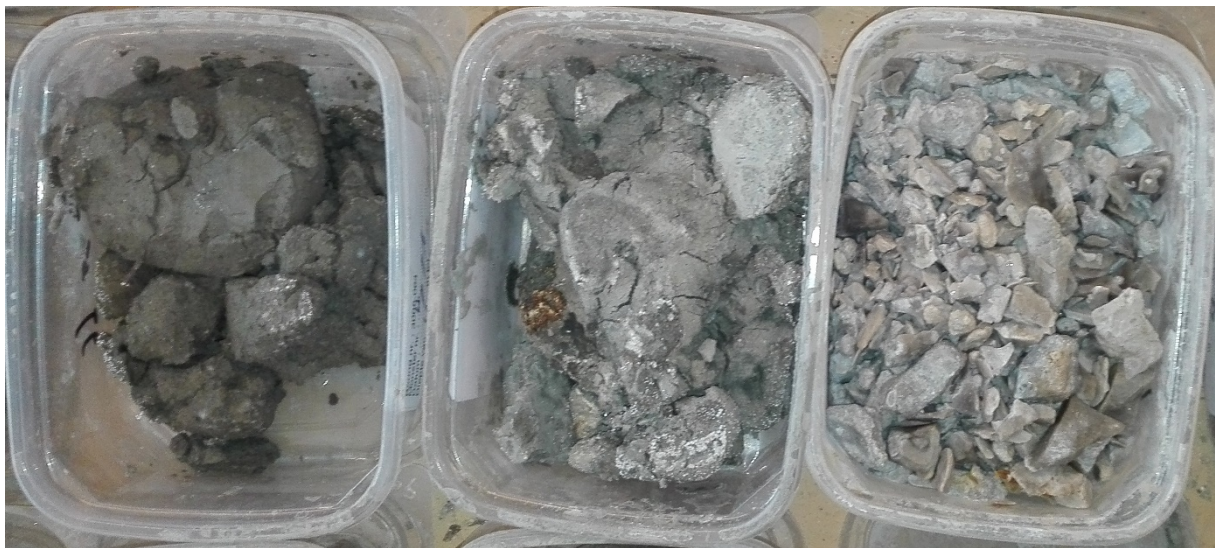
Foto 6. Cuttings interval 65 – 68 m, overgang van Landen Klei naar vuursteeneluvium, met grens Tertiair – Krijt op 66,50 m (in middelste monster).
