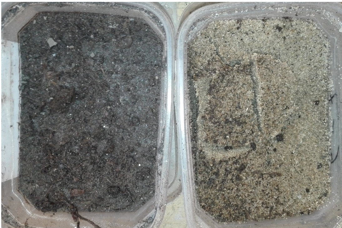
Foto 2. Cuttings interval 5 – 7 m in Pleistoceen matig-grof rivierzand; links (monster 5 – 6 m) donkergrijs gekleurd en vermengd met bovenliggend veen; rechts (monster 6 – 7 m) bleekbeige gekleurd sibvrij zand met talrijke donkere lignietkorrels.
