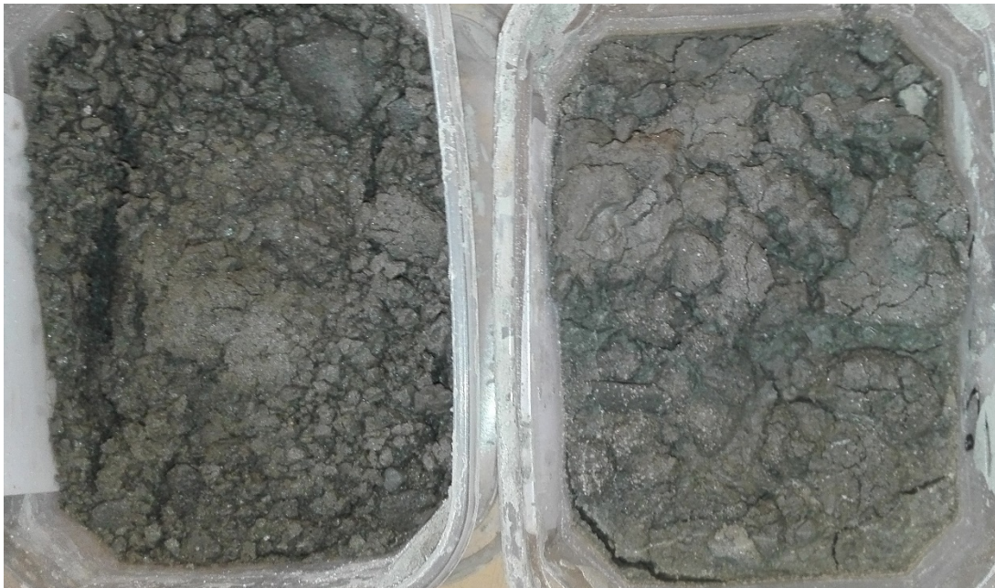
Foto 5. Cuttings interval 61 – 63 m in donkergrijze vervloeiende klei met mm-grote hardere kleisteenbrokjes en cm-grote bruingrijze septaria fragmenten, voorkomend aan de basis van de Formatie van Hannut in onbenoemde eenheid onder de Klei van Waterschei.
