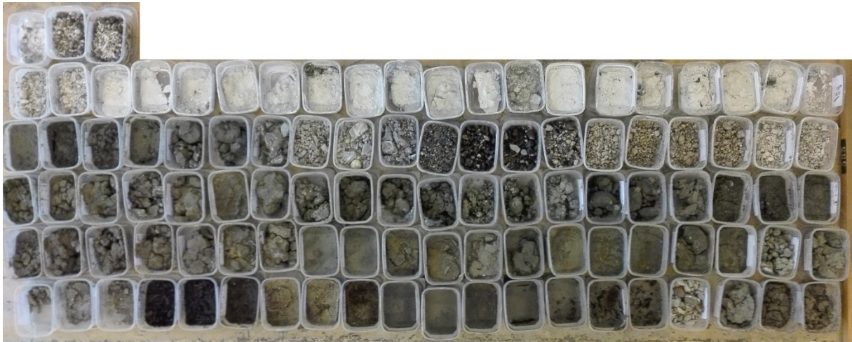
Foto 1. Overzicht cuttings in potjes per meter van 0 tot 103 m, in rijen van 20 m, beginnend van monster 0 – 1 m links onder.
