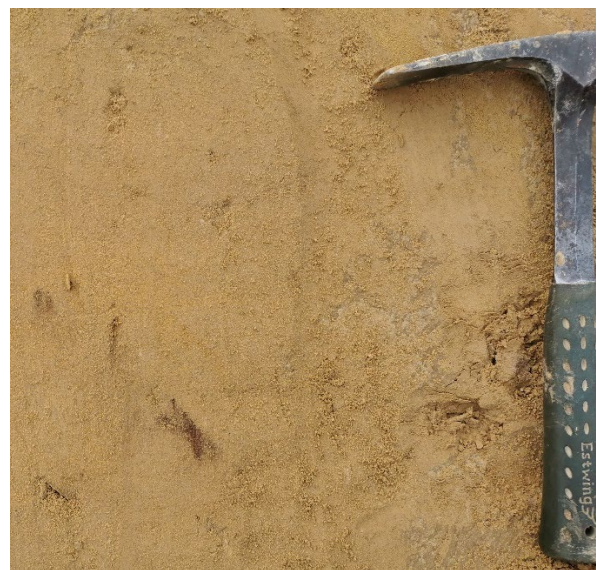
Interval 2.35 - 3.10 m, gele loess met verspreide meestal gebroken silex keitjes en bruine vlekjes.
