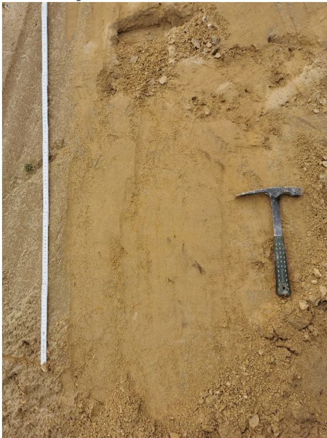
Interval 2.35 - 3.10 m, gele loess met verspreide meestal gebroken silex keitjes en bruine vlekjes.
