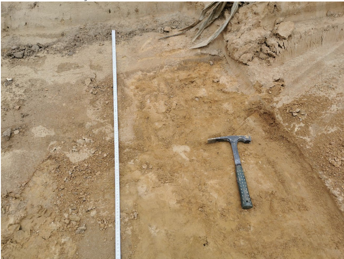
Overgang van roodachtig bruine gecompacteerd leem met blekere zandvlekken en kevergaten, op 5.65 m overgaand in bruine sterk verharde leem met gebleekte vlekjes die fijn doorworteld is.
