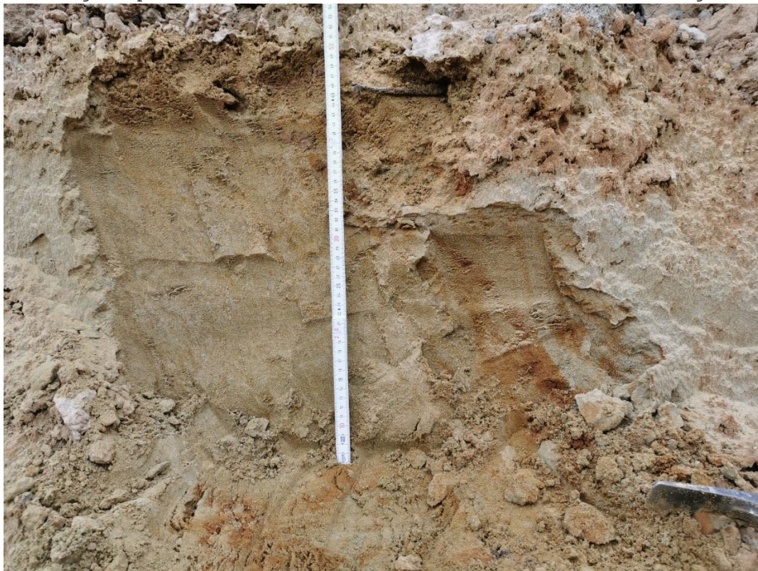
Basis van profiel 5 m ten noorden van hoofdprofiel, sectie 0.00 - 0.50 m in bleekgroengeel Zand Van Brussel met toenemend aantal roestvlekken naar boven en roestrode vlekken en strepen naar het noordoosten (in de richting van de Quartaire overdekking of erosie).
