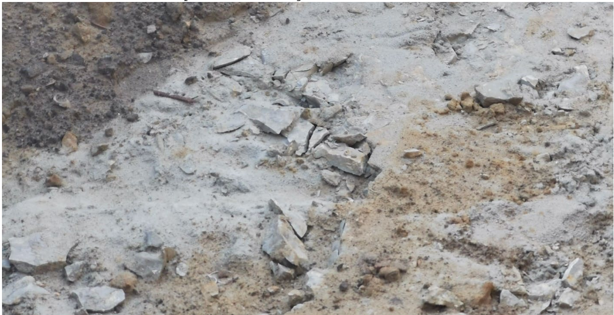
Zicht op de asgrijze kiezelzandsteenlaag op de bodem van de bouwput, met ondulerende vorm en brosse breuk.
