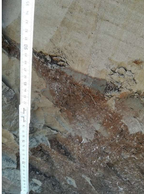
Figuur 10. Wand 3, observatiepunt 4. Schelpenbank van pakket 15-83 cm, waarbij de kleilaag bij de uitstulping zowel onder als boven de schelpenbank voorkomt. Foto F_VLA17-4-1-008-W3-02.
