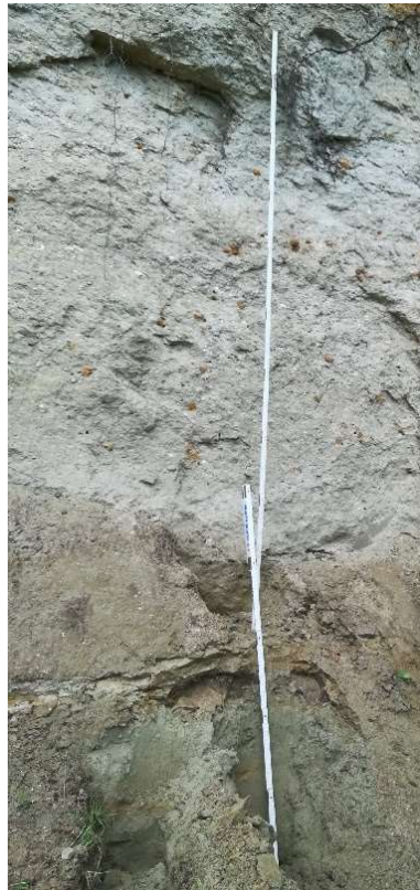
Figuur 13. Wand 4, observatiepunt 1. Onderaan is de afwisseling van klei- en zandlagen te zien; hierboven het dikke pakket met bleekgrijs schelphoudend zand. Foto F_VLA17-4-1-008-W4-01.
