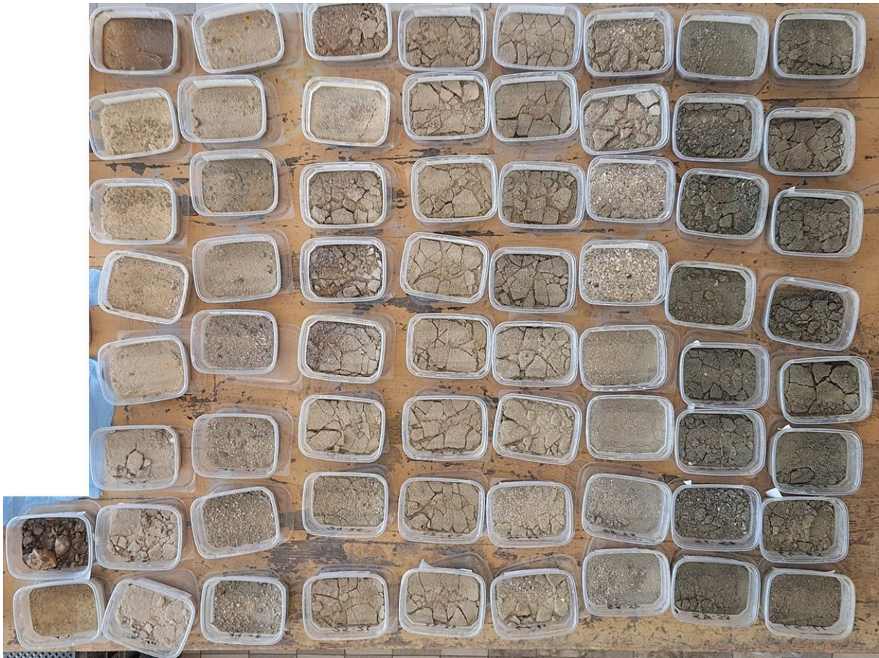
Boormonsters 17W357, per meter van linksboven naar rechtsonder.
