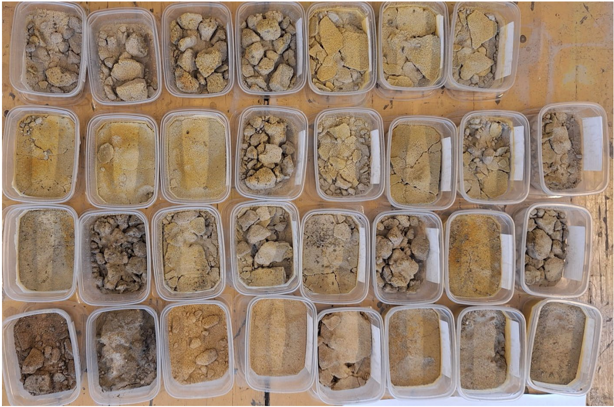
Boormonster 16W304, in monsterpotjes per meter van linksonder naar rechtsboven.
