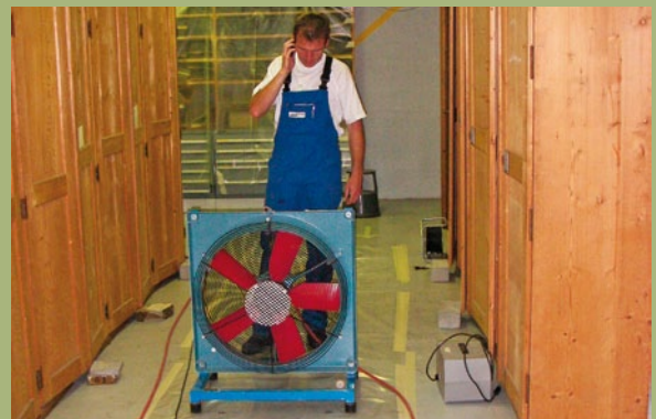
Désinfection des salles d'herbier. Ventilateur pour répartir le gaz dans les salles
