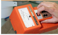
Radioactiviteit kan opgespoord worden met een geigerteller.
